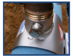
Serrer la vis de blocage du robinet, en butée avec une clé de 13
