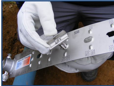
Insérer la vis dans le trou identifié puis revisser
