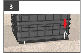
En cas d'instabilité, le corps enterré peut-être ancré au sol avec des fers à béton placés dans les orifices prévus à cet effet.
