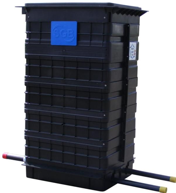
Les regards enterrés Multicompact' permettent **l'installation, la relève et l'entretien rapide** de plusieurs compteurs d'eau en ligne **DN15 longueur 110mm ou 170mm** dans le domaine public ou privé à partir d'un seul branchement sur la canalisation.
