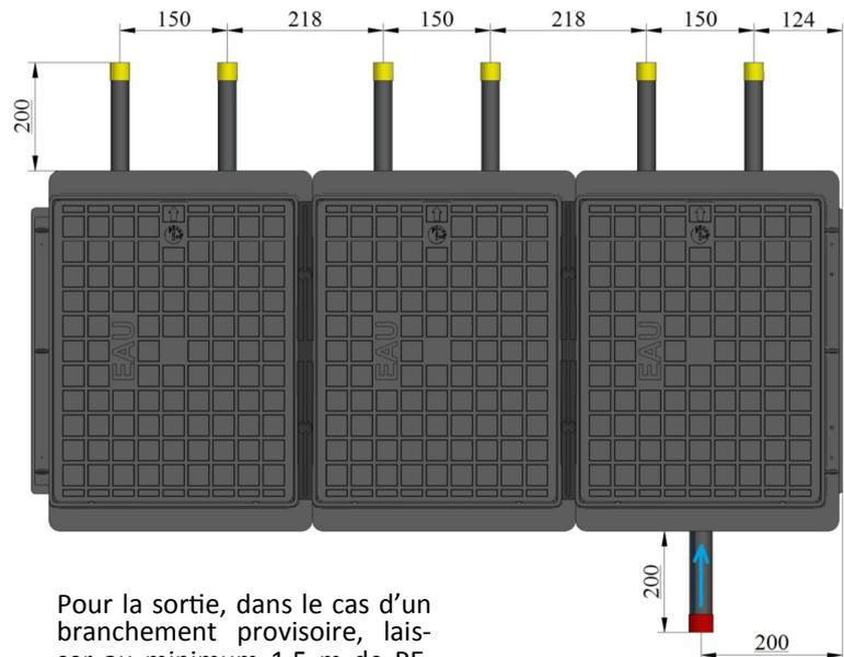
Pour la sortie, dans le cas d'un branchement provisoire, laisser au minimum 1,5 m de PE. Sinon, réaliser le branchement direct de l'abonné.
