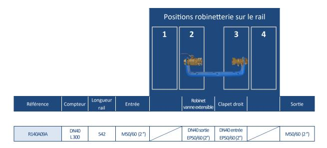
♠ Robinet-vanne droit non verrouillable + Douille fixe — Douille coulissante + Clapet droit
